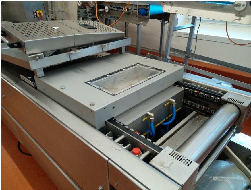
Abbildung 3: Matrix-Vorheizung in WEBOMATIC-Tiefziehmaschine bei Bedford integriert
