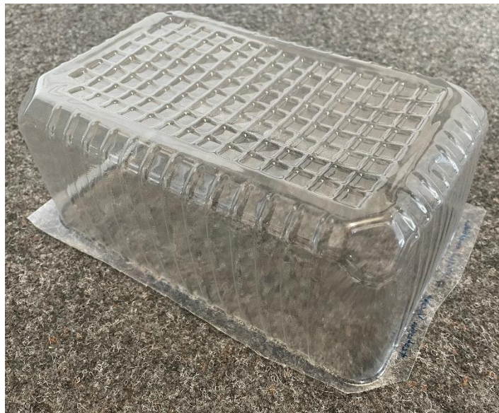
Abbildung 2: Geformte Unterfolie der optimierten Verpackung mit 450µm Foliendicke
